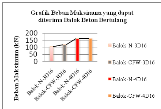
Gambar.13. Grafik beban maksimum yang dapat diterima balok beton bertulang.
