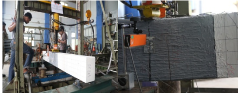
Gambar 16. Retak pertama yang terjadi pada balok 3D16 CFW .
