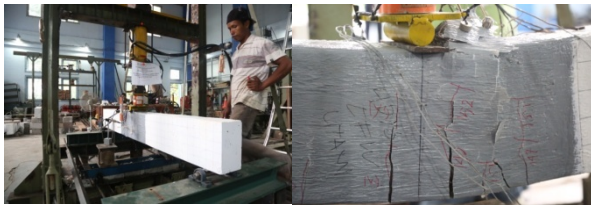
Gambar 22. Retak pertama yang terjadi pada balok 4D16 CFW.
