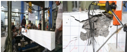
Gambar 20. Retak pertama yang terjadi pada balok 4D16 Normal (tanpa CFW).
