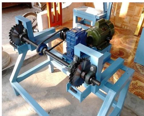
**Gambar 8a. Alat Pengupas Batok Kelapa**
