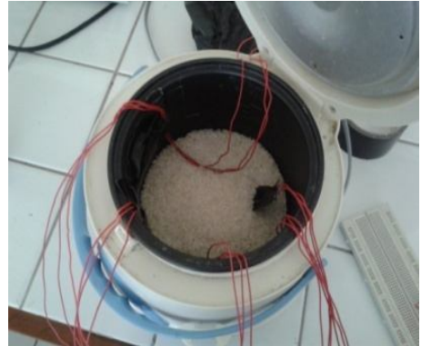
Gambar 5. Foto Pengujian Distribusi Suhu
