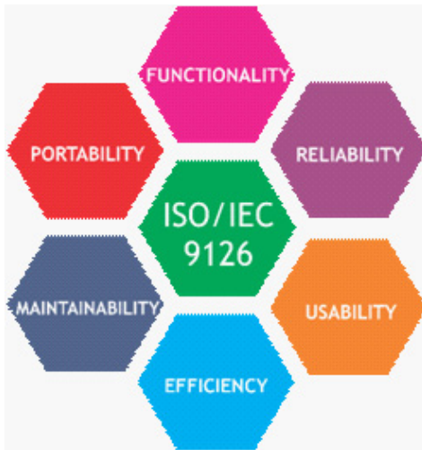
Gambar 2. Karakteristik perangkat lunak dalam ISO / IEC 9126
