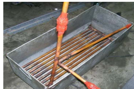
Gambar 2. Evaporator Pipa Pararel dari Tembaga
